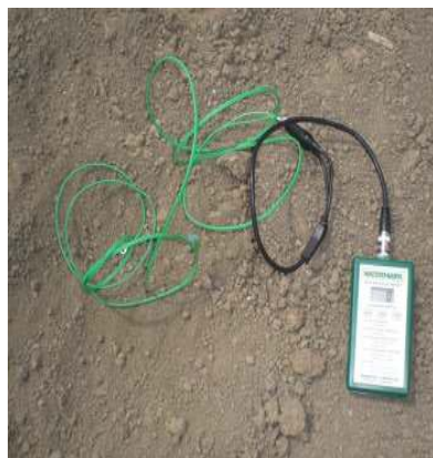
Gipsani blokovi (foto. Cerjan, 2011.)
